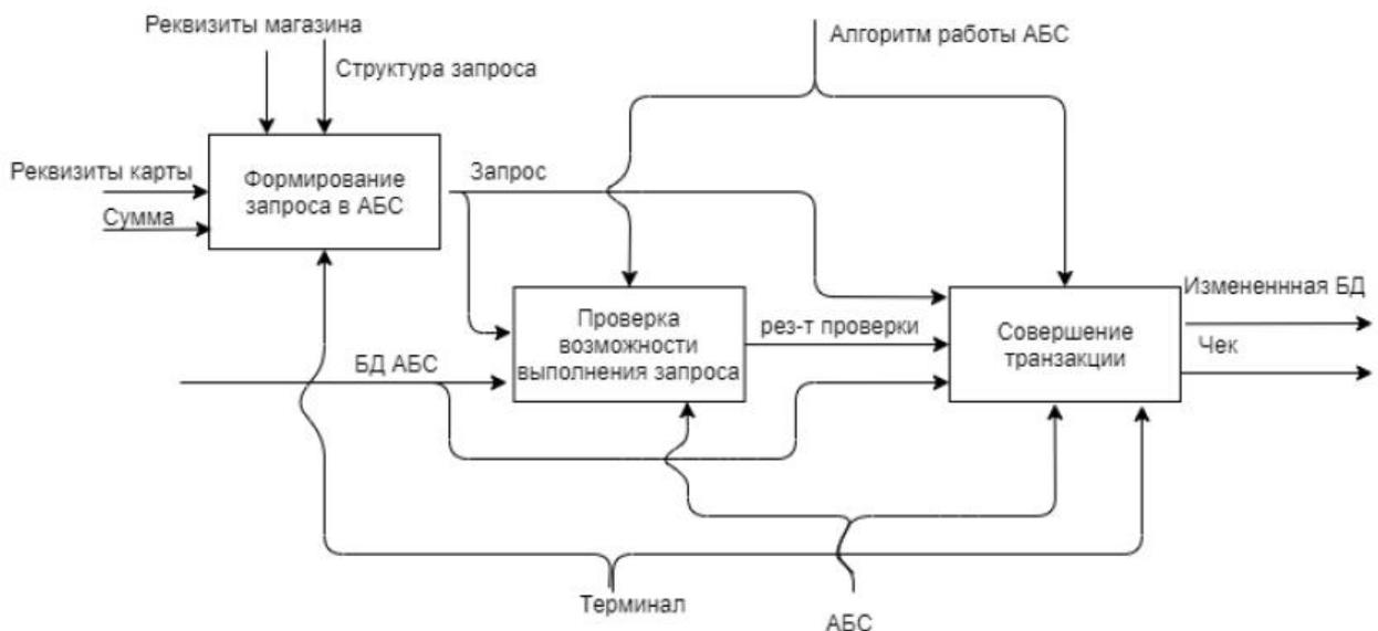
Рисунок 2.1 – Декомпозиция процесса в нотации IDEF0
