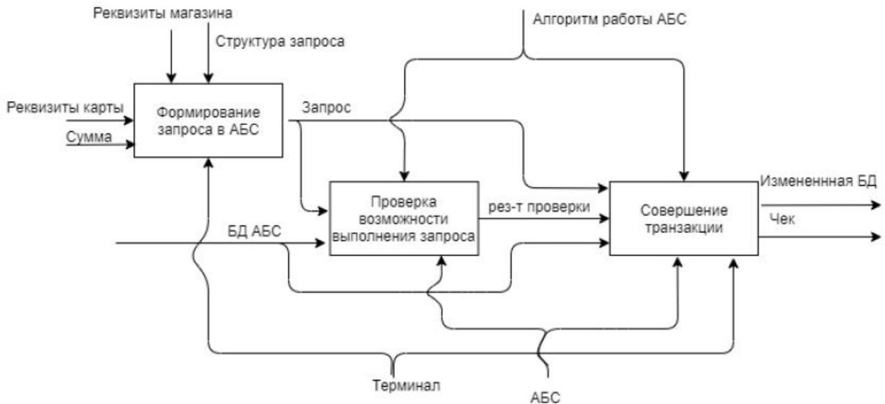
Рисунок 1.2 – Декомпозиция процесса в нотации IDEF0
