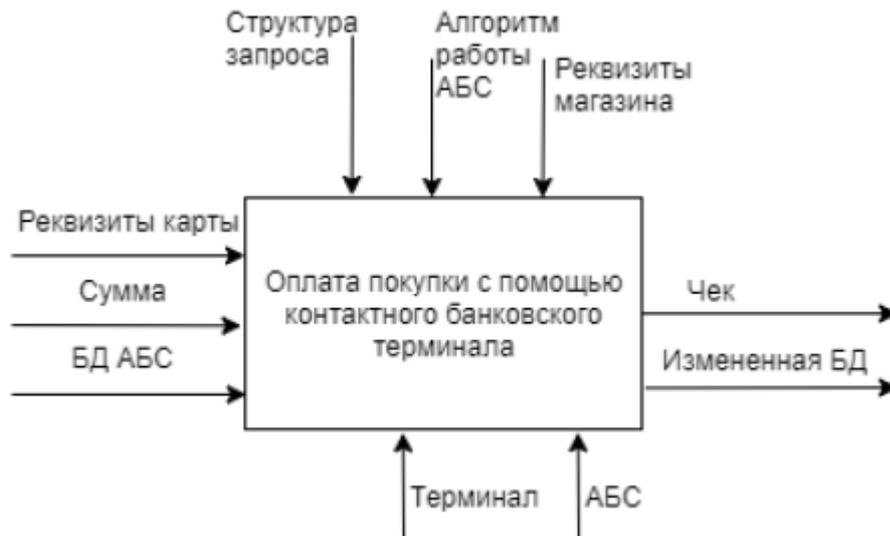
Рисунок 1.1 – Модель «чёрного ящика» процесса в нотации IDEF0
