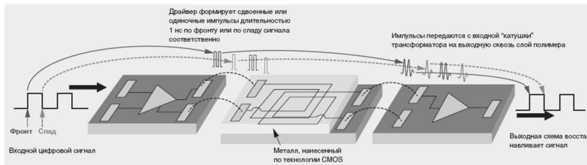
Рис. 2.28. Принцип действия изолятора iCoupler®
