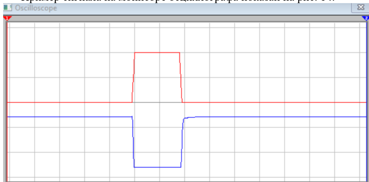
Рисунок 14. Пример входного и выходного сигналов на экране осциллографа При превышении максимальной частоты входного сигнала, сигнал на выходе начинает искажаться (рис. 15).
