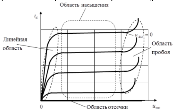
Рисунок 5. Семейство стоковых характеристик полевого транзистора
