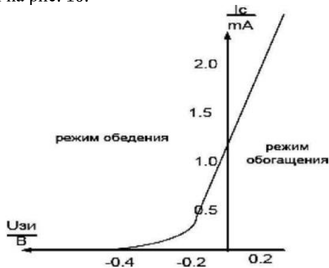
Рисунок 10. – Стоко-затворная характеристика МДП-транзистора со встроенным каналом
