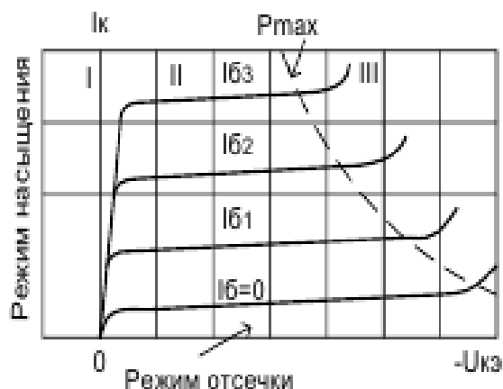
Рисунок 3 – Выходные характеристики транзистора с ОЭ
