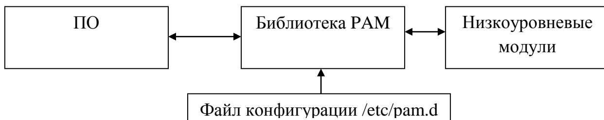
Рисунок 1 – Библиотека PAM обрабатывает файл pam.d и загружает соответствующие модули
